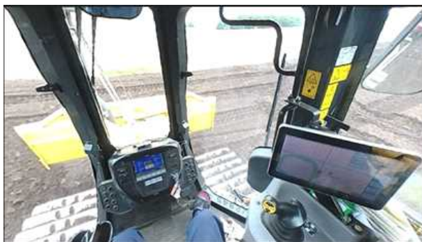
▲ 自動操舵システム搭載のトラクター内
